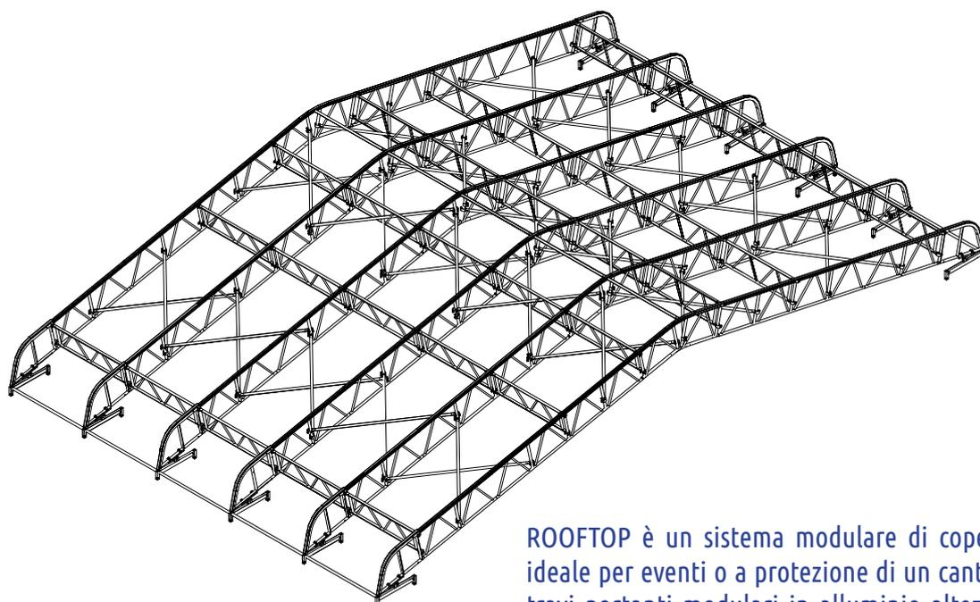
ROOFTOP è un sistema modulare di copertura progettato a doppia falda ideale per eventi o a protezione di un cantiere. La struttura è realizzata con travi portanti modulari in alluminio altezza 74cm con guide integrate per l'inserimento di teli di copertura in PVC.
